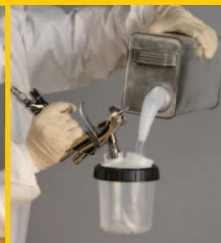
PPS™ 塗装用カップシステムは、塗装作業の効率化、健康・環境への負荷軽減を目的として開発されたシステムです。さまざまな塗料・スプレーガンにご使用いただけます。
